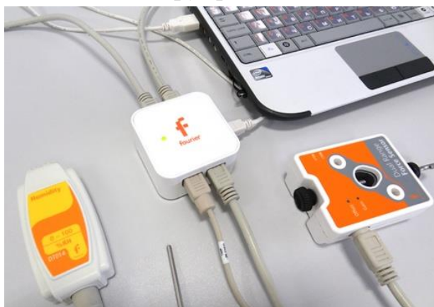
Рис. 2. USBLink – простое многофункциональное устройство типа «plug-n-play»
